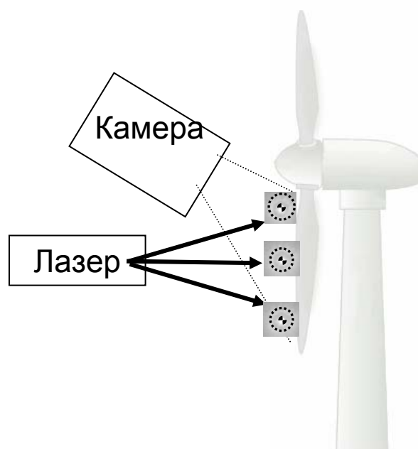
Рис. 12. Иллюстрация диагностики наледи на лопастях ветрогенератора
