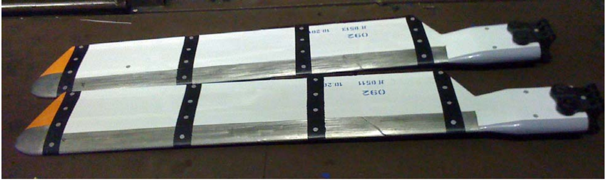
Рис. 2. Лопасти с нанесенными на поверхность маркерами
