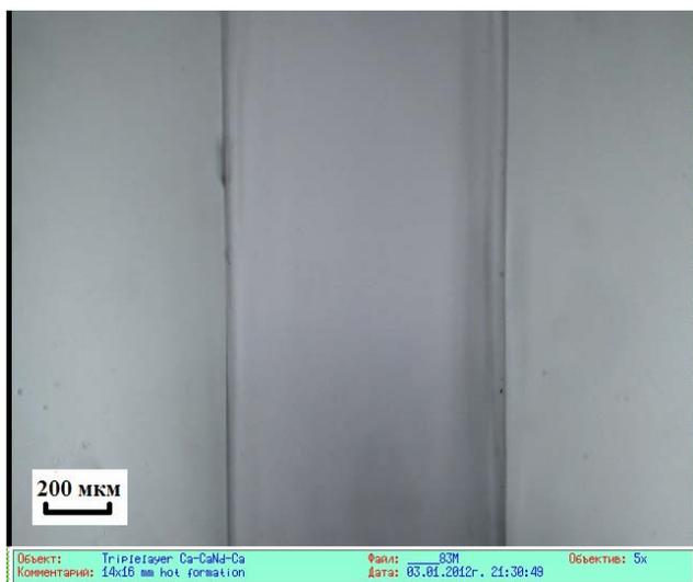
Рис. 3 – Полученное с помощью микровизора изображение грани волноводной структуры, в которой отражающая оболочка состоит из чистых кристаллов  $\text{CaF}_2$ , а сердцевина – из керамики  $\text{CaF}_2:\text{Nd}$ , линейный размер сердцевины  $\approx 800$  мкм
