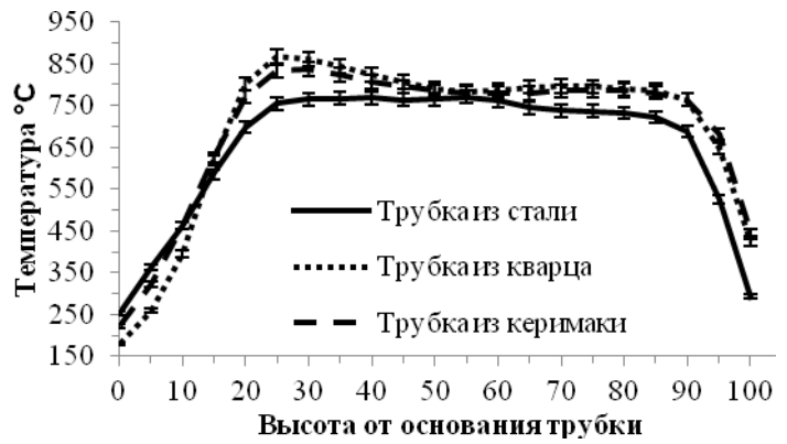
Рис. 4. Профиль температуры стенки в зависимости от материала камеры
