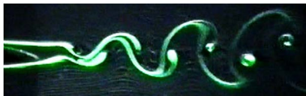
Рис. 4. Вихревая дорожка за несимметричным профилем SI-129. \alpha=0^\circ , Re = 10000
