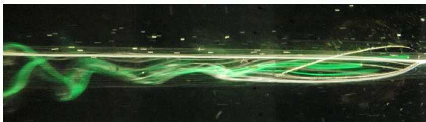
Рис. 3. Возникновение спиралевидной трубки вокруг оси концевой вихря, распад концевой вихря, \alpha = 10^\circ , Re = 10000
