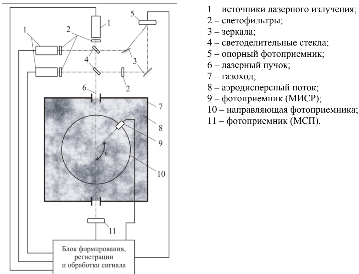
Рис. 2. Схема установки для одновременного проведения измерений методом спектральной прозрачности и методом интегрального светорассеяния.
