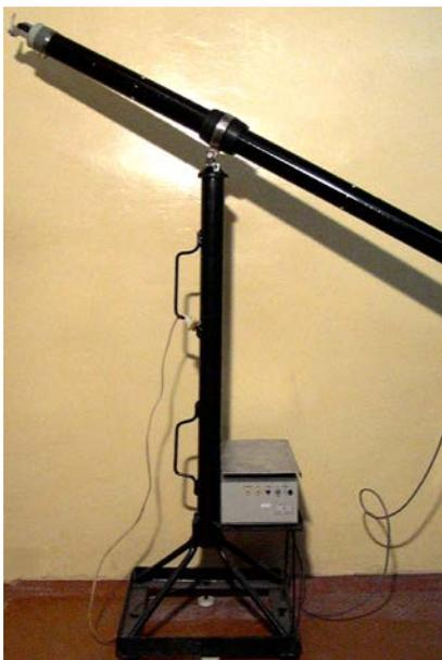
Рис. 1. Лазерная установка с формирователем светового «ножа»
