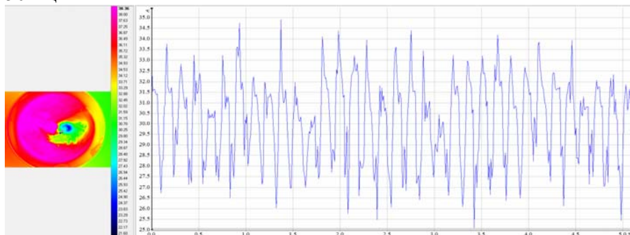
Рис. 2. Температурные пульсации при смешении воды, снятые через ИК прозрачное окно
