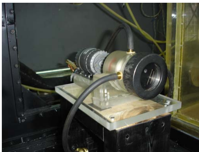
Рис. 1. Полезная модель с устройством, задающим частоту смешения воды
