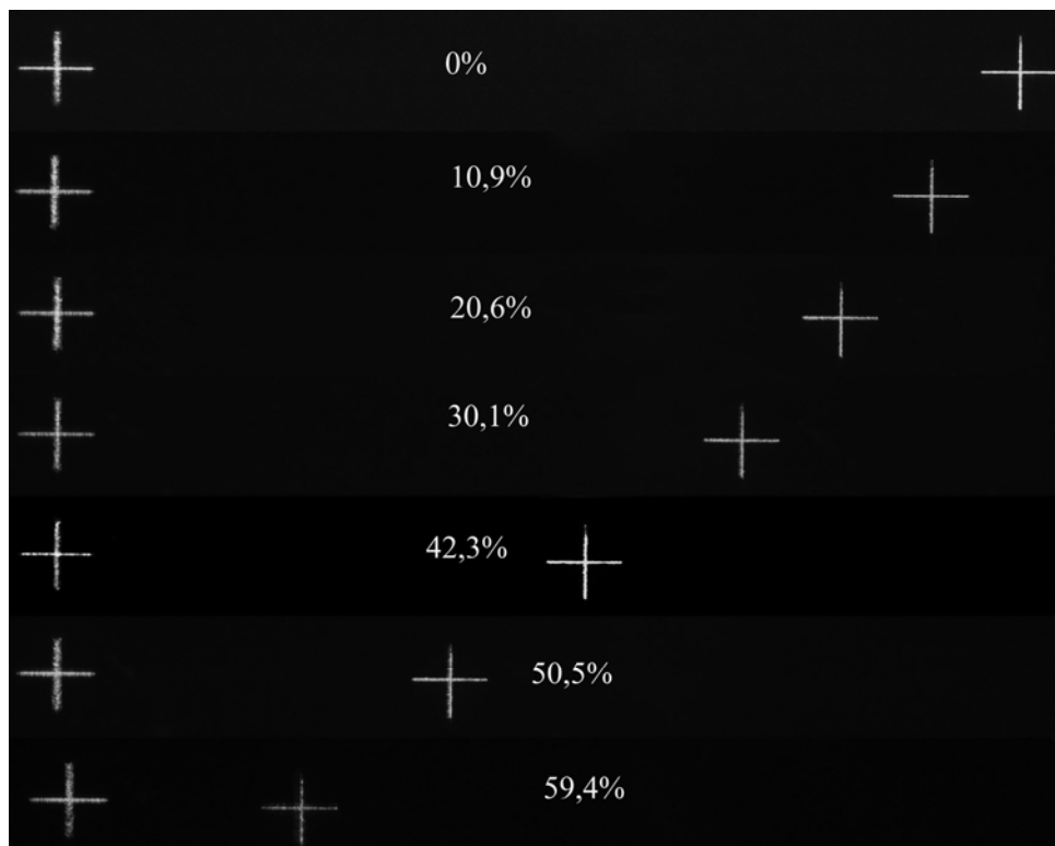
Рис. 4. Отклонения изображения для различных концентраций раствора
