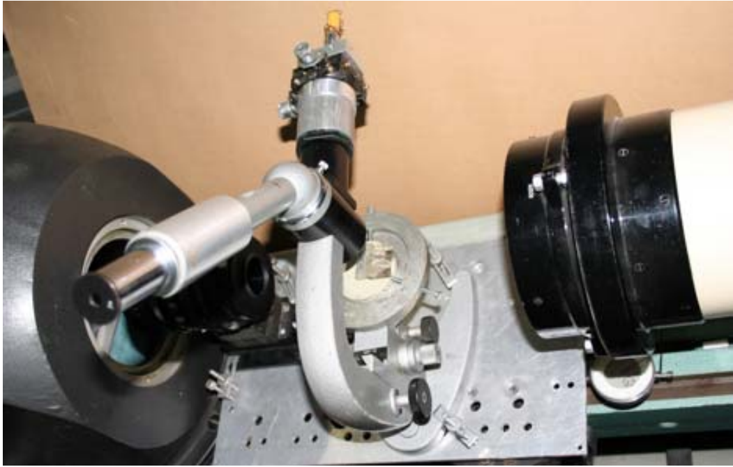
Рис. 6. Общий вид экспериментальной установки с дистанционным измерителем толщины слоя жидкости на базе микроскопа МБР-1 и длиннофокусного светосильного фотообъектива «Юпитер-6»
