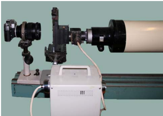
Рис.2. Осветительный блок автоколлимационного теневого прибора с двухканальным фильтром Фуко–Гильберта
