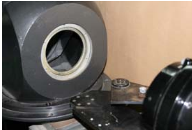
Рис.3. Коллиматорный объектив теневого прибора с диагональным зеркалом
