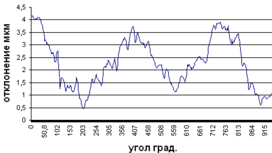
Рис.10. Изменение радиуса цилиндра от угла поворота
