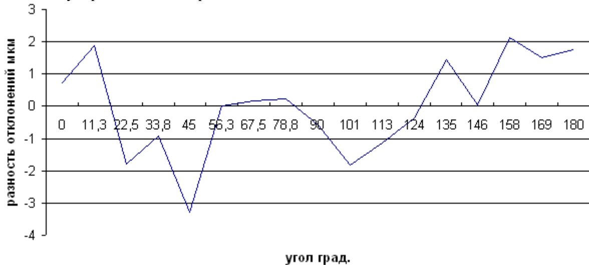
Рис. 9. Разность отклонений диаметра, измеренных методом ЛДА и микрометром
