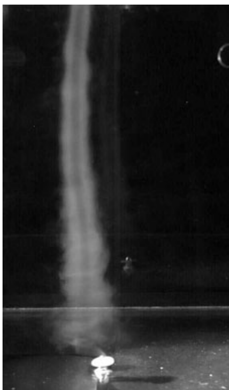
Рис. 1. Фотография торнадоподобного вихря, визуализированного дымом, поступающим в центре нижней поверхности
