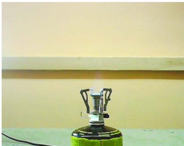
Рис. 8. Фотография газовой горелки без рассекателя в процессе горения
