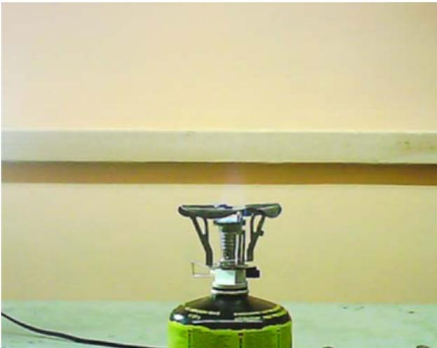
Рис. 12. Фотография газовой горелки с рассекателем сложной формы в процессе горения
