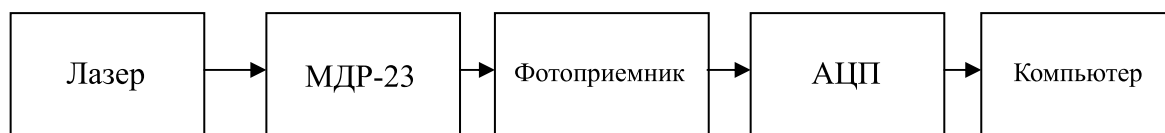
Рис. 1. Схема установки для исследования спектров излучения лазерных диодов
