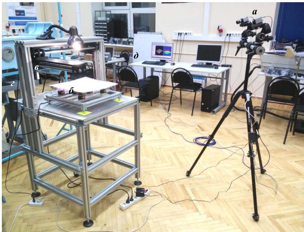
Рис 6. Внешний вид комплекса автоматического определения погрешности МКФИ: а – стереосистема видеокамер; б – имитатор деформируемой поверхности; в – линейные модули перемещения; г – оптический датчик расстояния; д – персональный компьютер
