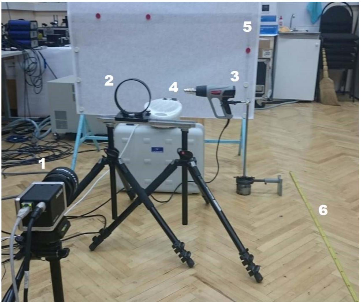
1) видеокамера, 2) исследуемый объект, 3) монтажный фен, 4) вентилятор, 5) фоновый экран, 6) линейка
