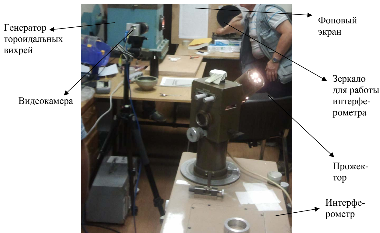
Рис. 1. Часть экспериментальной установки с реализацией теневого фонового метода
