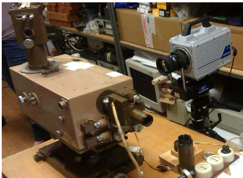
Рис. 2. Часть экспериментальной установки с реализацией интерферометра для контроля измерений
