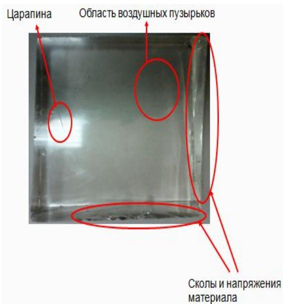
Рис. 1. Фотография плоскопараллельной пластины
