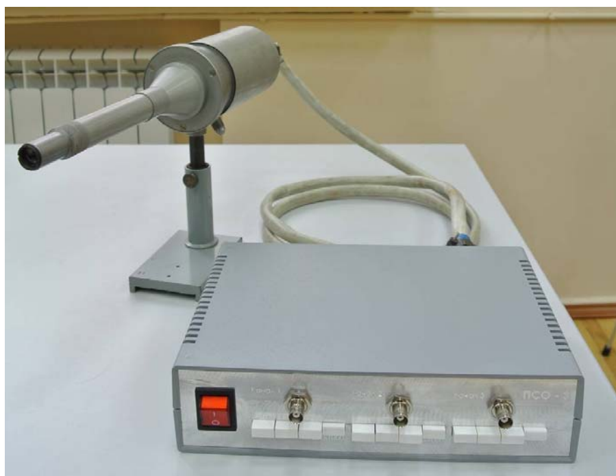
Рис. 4. Внешний вид PCS-3 в составе измерительного зонда, блока управления и питания и интерфейсного кабеля
