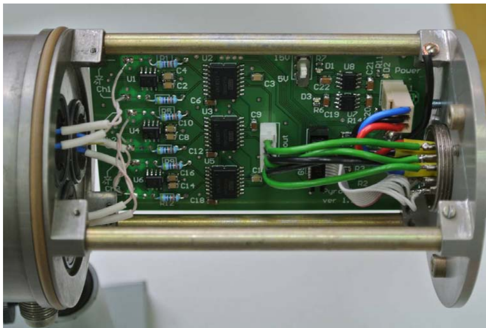
Рис. 3 – Зонд пирометра с установленной платой усиления
