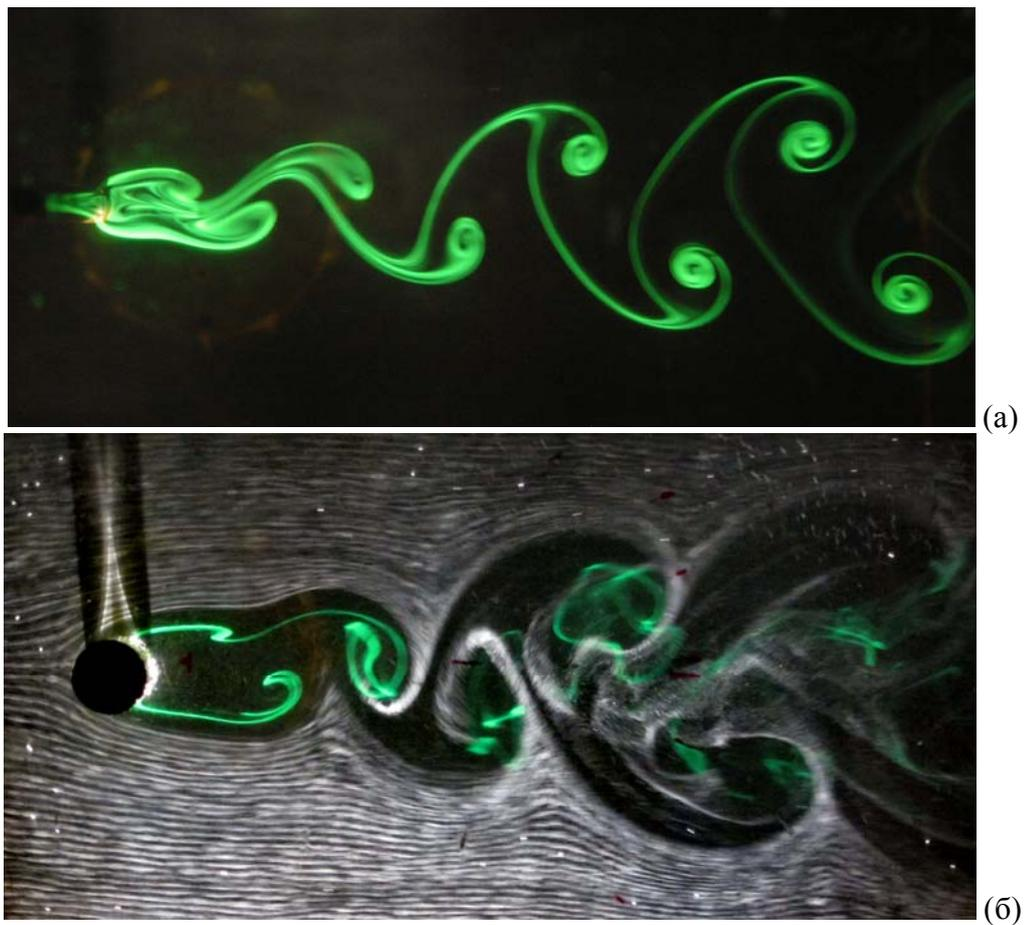
Рис. 5. Структура вихревого следа за круговым цилиндром:
