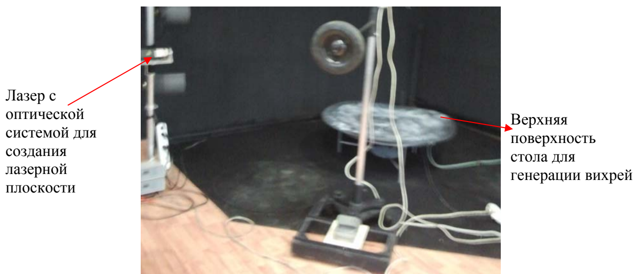
Рис. 1. Фотография экспериментальной установки для генерации вихревых структур
