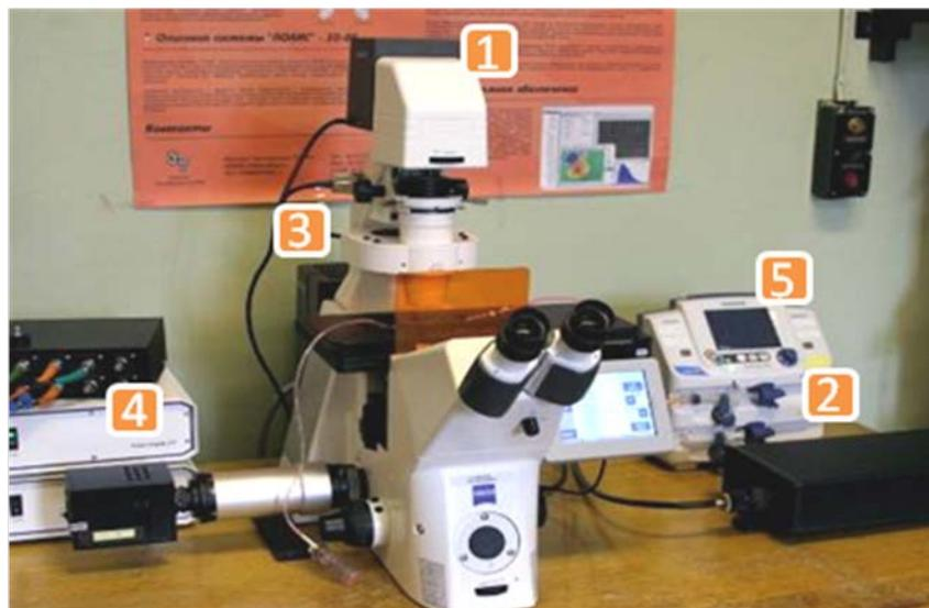
Рис. 1. Фотография экспериментальной установки для проведения micro-PIV экспериментов
