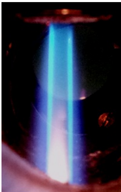
Рис. 2. Фотография пламени в n -декане в горельном устройстве.
