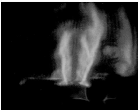
Рис 1. Шлиренграмма структуры потоков, нагретого газа в промежутке между полосами СПР (кратность увеличения  $5^x$ )
