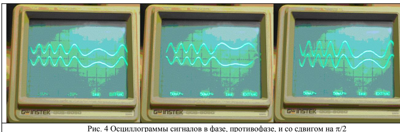
Рис. 4 Осциллограммы сигналов в фазе, противофазе, и со сдвигом на  $\pi/2$
