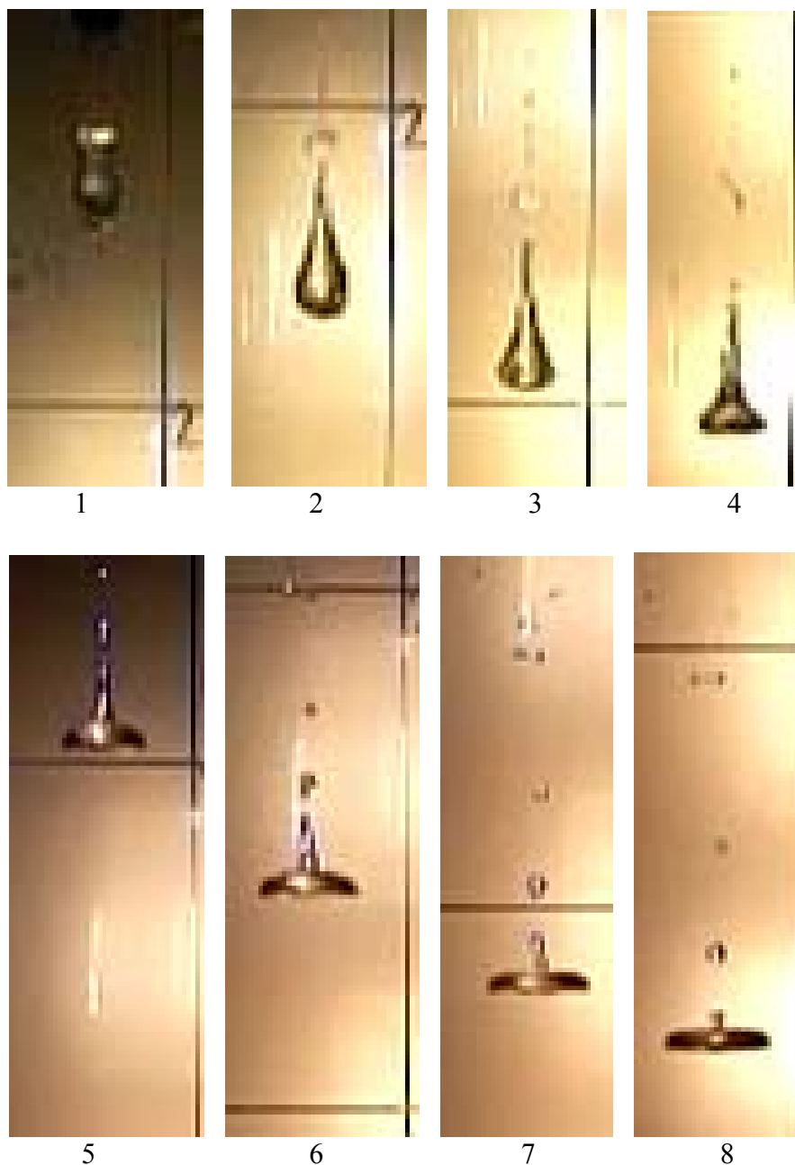
Рис.3. Трансформация цилиндрического водяного снаряда (объем 45 мл, отношение высоты к диаметру 2,4) при его свободном падении. Под действием аэродинамических сил цилиндр приобретает каплевидную форму (кадры 1 – 3), затем приобретает форму шурупа (кадр 4) и постепенно превращается в плоский диск (кадры 5 – 8). На рисунке приведены кадры двух разных опытов (кадры 1 – 4, интервал высот падения \sim 0 - 1 м; кадры 5 – 8, интервал \sim 1 - 2 м). На кадре № 6 расстояние между реперами (две горизонтальные линии) – 0,4 м. Скорость съемки 1200 кадров в секунду
