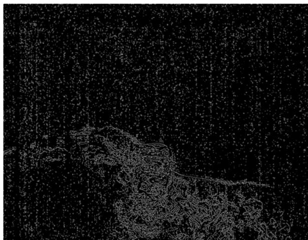
Рис. 5. Результат поиска границ интенсивности изображения по Канни без предварительной фильтрации
