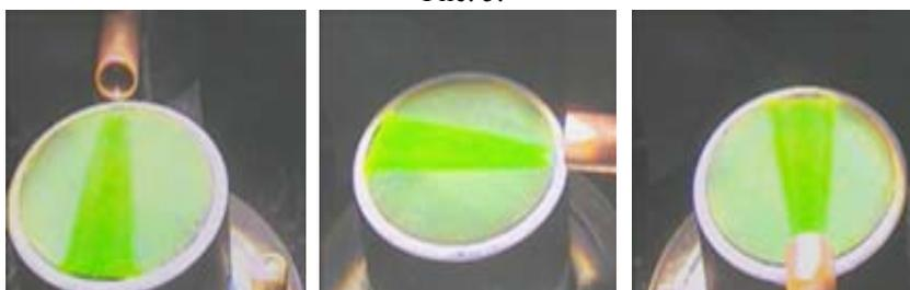
Рис.6. Отсутствие угловой зависимости у планарной текстуры, полученной с помощью текстурного перехода
