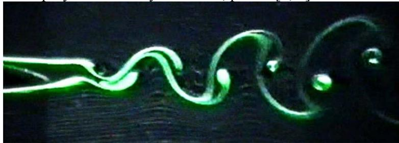
Рис. 3. Вихревая дорожка за несимметричным профилем SI-129.  $\alpha = 0^\circ$ ,  $Re = 10000$
