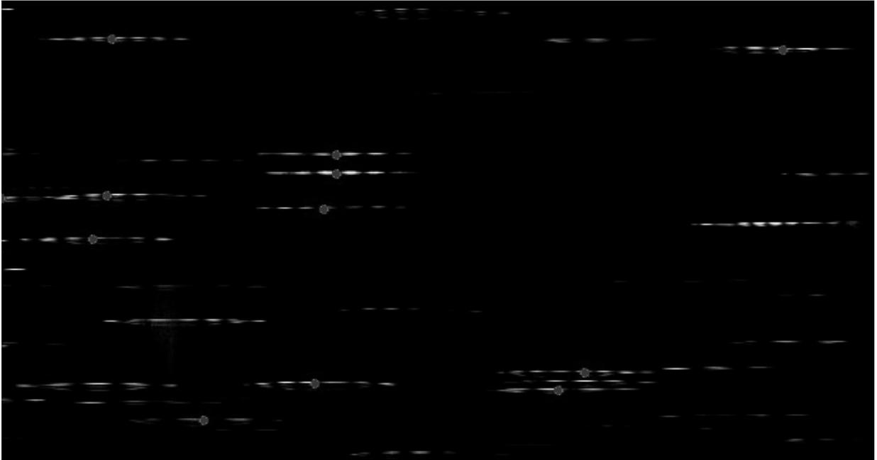
Рис.5. Увеличенная часть измерительной области факела форсунки после проведенной обработки методом IPI, кругами показаны центры частиц
