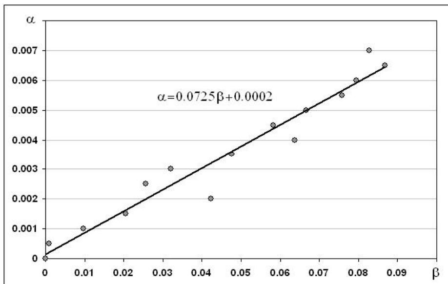
Рис. 7. Градуировочная зависимость  $\alpha(\beta)$ , снятая на фиксированной центральной частоте  $f_0T$
