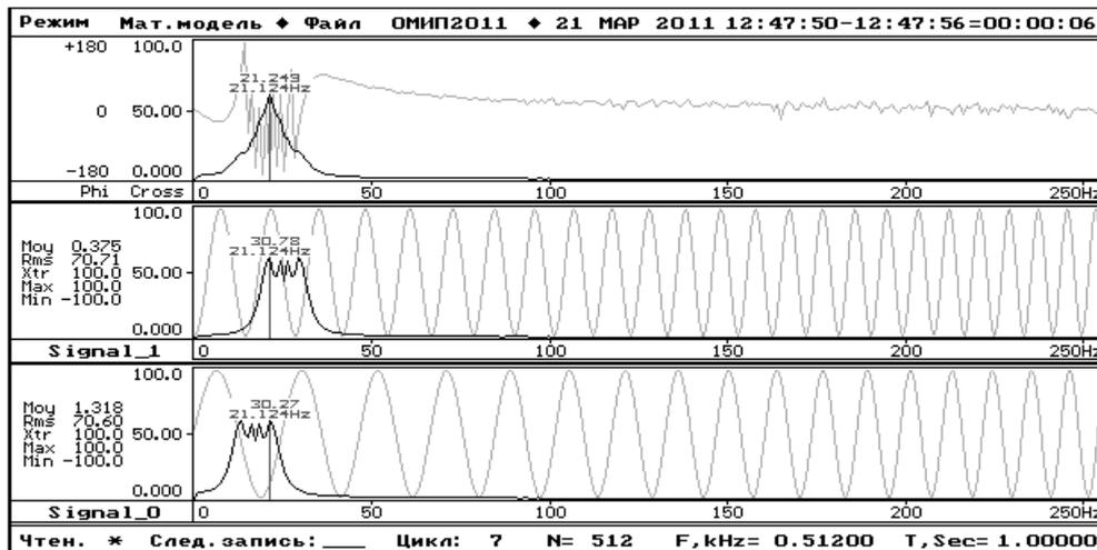
Рис. 1. Спектральный анализ линейно частотно-модулированного сигнала
