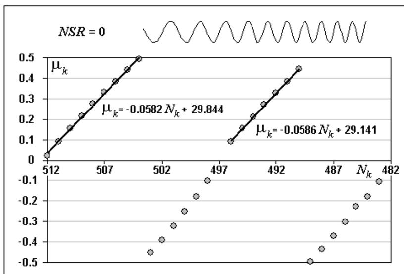
Рис. 3. Поведение характеристики  $\mu_k(N_k)$  чистого ЛЧМ-сигнала
