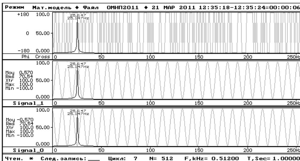
Рис. 2. Спектральный анализ чистого гармонического сигнала
