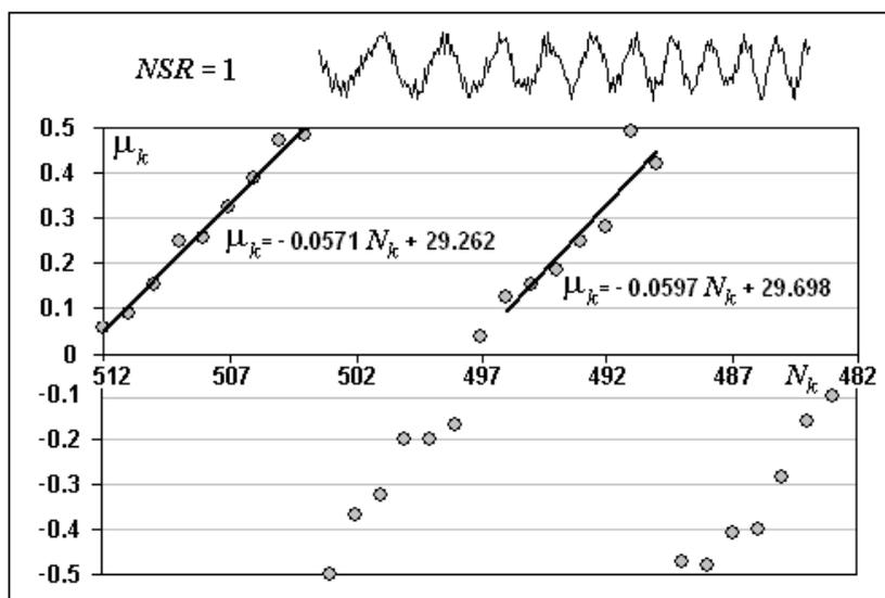
Рис. 4. Поведение характеристики  $\mu_k(N_k)$  зашумленного ЛЧМ-сигнала
