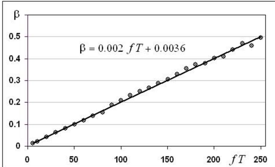
Рис. 8. Градуировочная зависимость  $\beta(fT)$ , снятая для фиксированного значения параметра  $\alpha$
