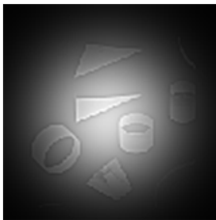
Рис. 6. Визуализация сложного фазового объекта термокапиллярной ячейкой Цернике
